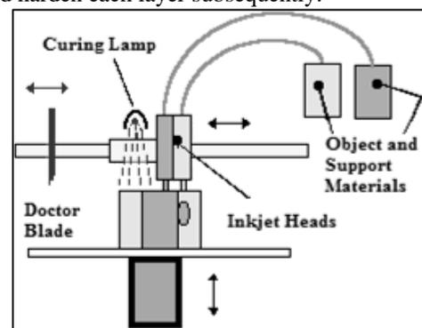
Fig. 1: Polyjet Process
