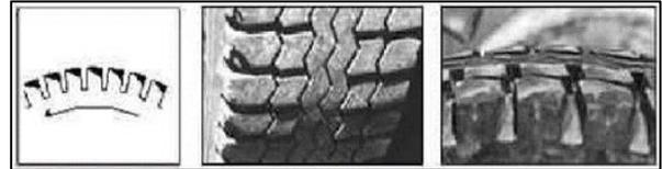
Fig. 10: Heel & Toe Wear
