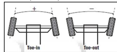
Fig. 15: Toe-In Toe-Out Setting
