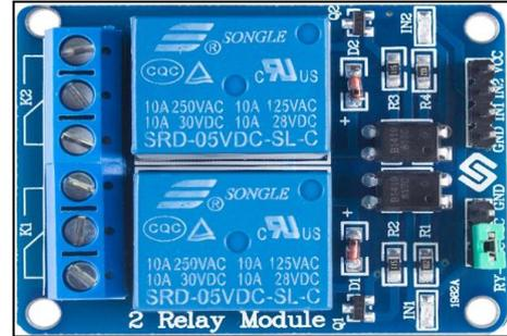
Fig. 3: 2 channel 5V Relay Module
