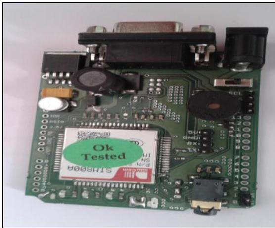
Fig. 2.6: GSM module
