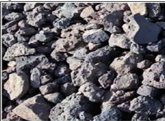
Fig. 2: Steel Slag
