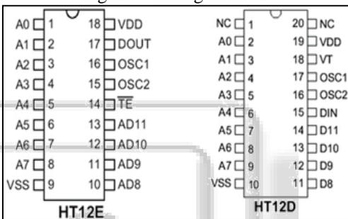
Fig. 3: Encoder and Decoder IC
