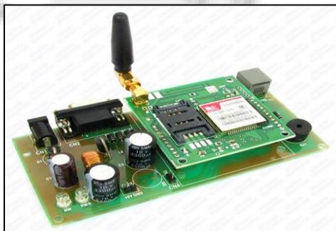
Fig. 3: GSM Module
