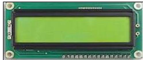
Fig. 5: LCD display
