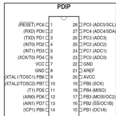
Fig. 4: Microcontroller-ATMEGA8
