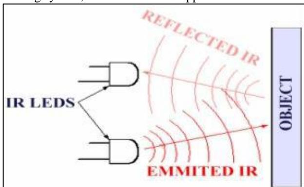
Fig. 3: IR Sensor Rays
