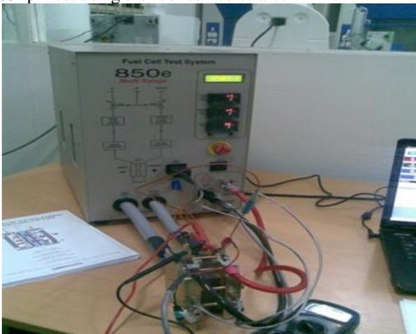
Fig. 3: Test Station 850e
