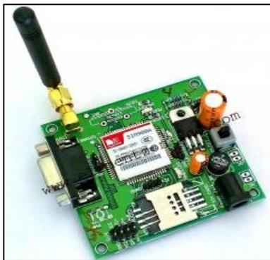
Fig. 5: GSM Module
