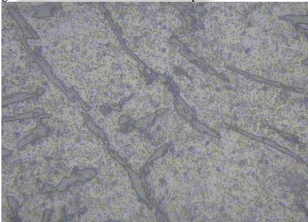
Fig. 2: (d) Microstructure of 6% SiC+5% Fly Ash at Magnification of  $\times 1000$
