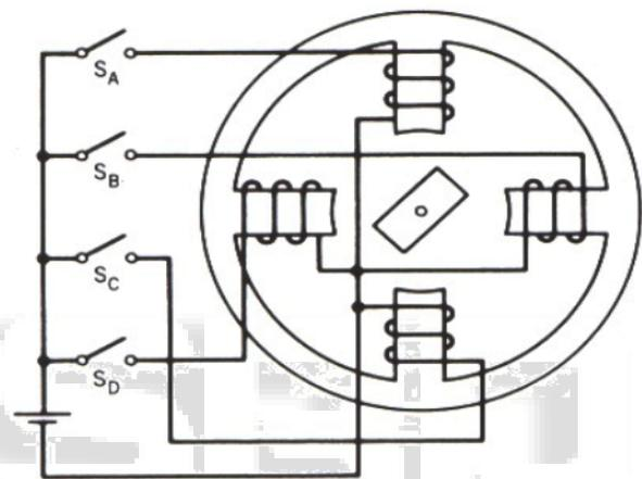
Fig. 1: CONFIGURATION OF STEPPER MOTOR
