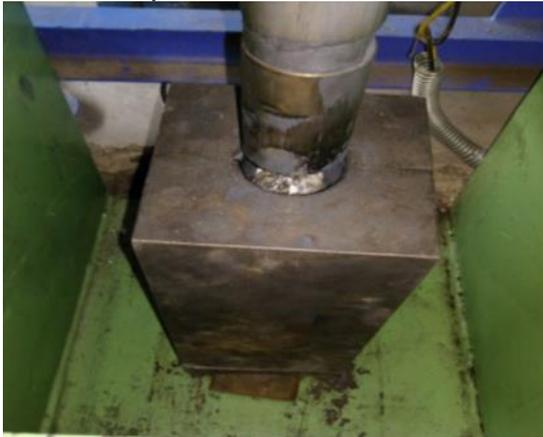
Fig. 1: Squeeze casting die
