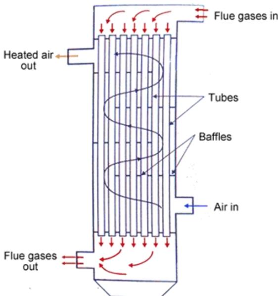
Fig. 1.2: Tubular Air Preheater [28].
