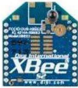
Fig. 3: X Bee /X Bee-PRO ZB RF Modules
