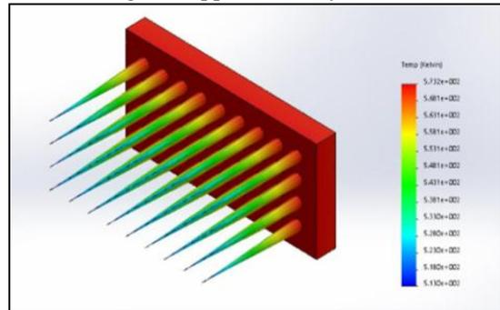
Fig. 8: Tapper Fin ( Aluminium Alloy 1060)
