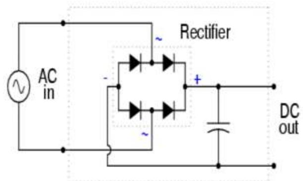
Fig. 5: Rectifier circuit
