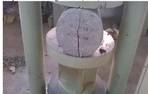
Fig. 2: Split Tensile Test
