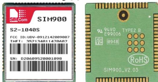
Fig. 10: GSM Module
