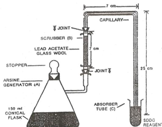
Fig. 3: Modified Gutzeit apparatus
