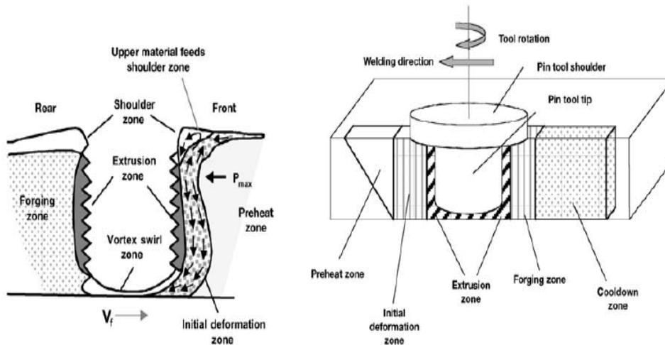
Fig. 2.5: Arbegast Metal Working Model<sup>[18]</sup>
