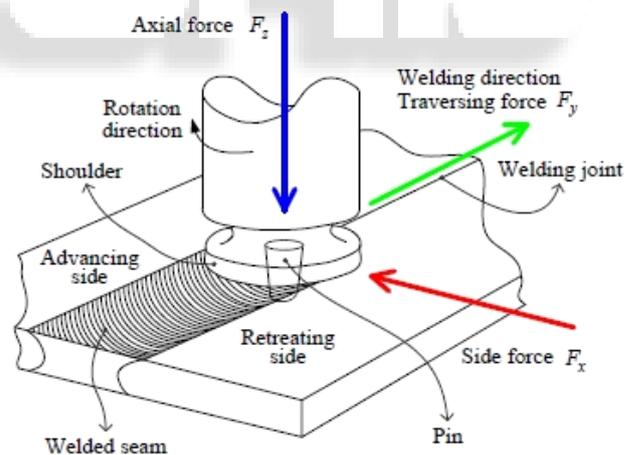
Fig. 1.1: FSW Principle<sup>[4]</sup>
