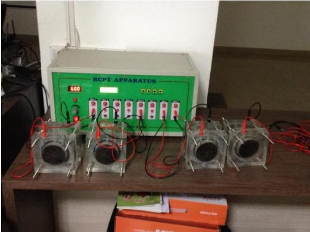
Fig. 3: RCPT apparatus
