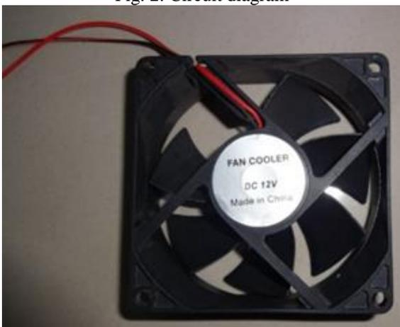
Fig. 3: SMPS fan (C.P.U. fan)
