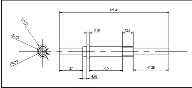
Fig. 2: Aluminium Shaft
