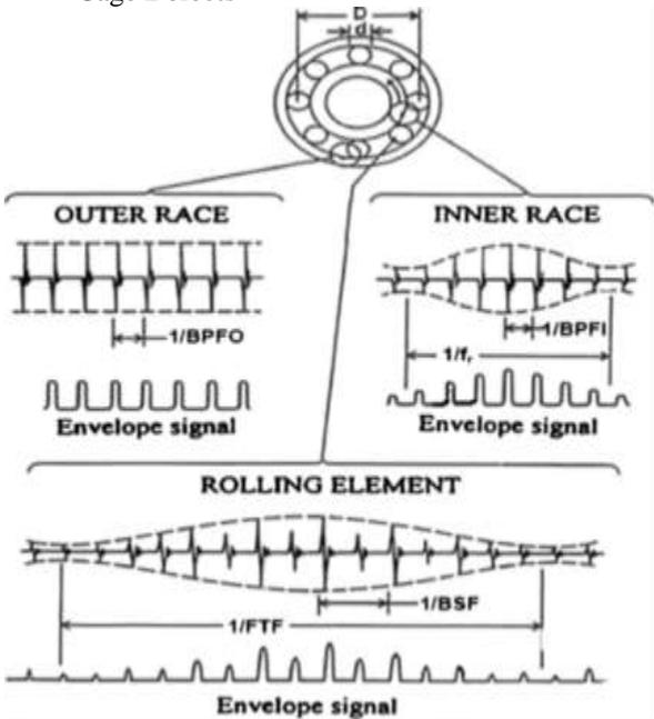
Fig. 2(A): Bearing Fault
