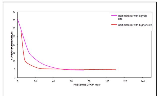
Fig. 5: PRESSURE DROP VERSUS COMBUSTOR HEIGHT
