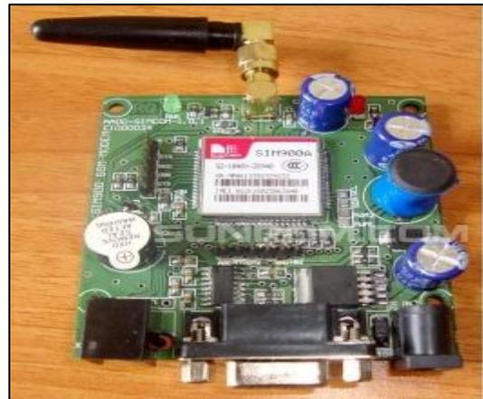
Fig. 2: GSM module
