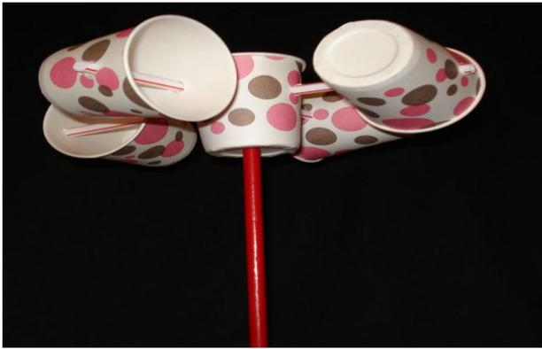
Fig. 1: 4 CUP ANEMOMETER
