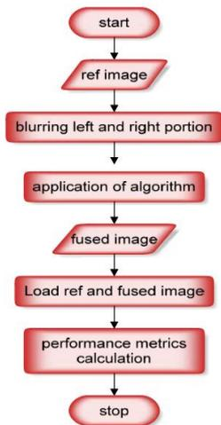
Fig. 10: Image fusion algorithm<sup>[3]</sup>
