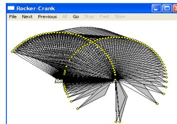
8)  $r_1=0.10, r_2=0.04, r_3=0.15, r_4=0.09$
