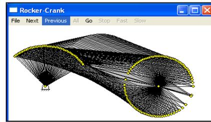
11)  $r_1=0.10, r_2=0.04, r_3=0.10, r_4=0.2$
