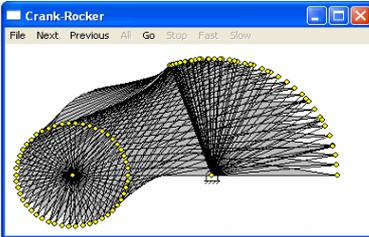
9)  $r_1=0.10, r_2=0.04, r_3=0.16, r_4=0.09$
