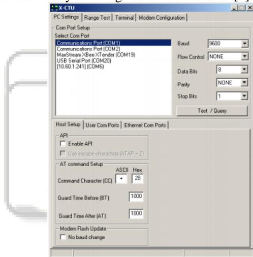
Fig. 8: X-CTU Setup
