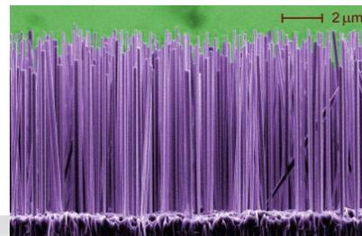
Fig 6 : Silicon nanowires
