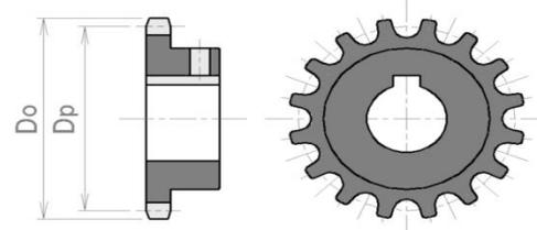
Fig. 2: Sprocket
