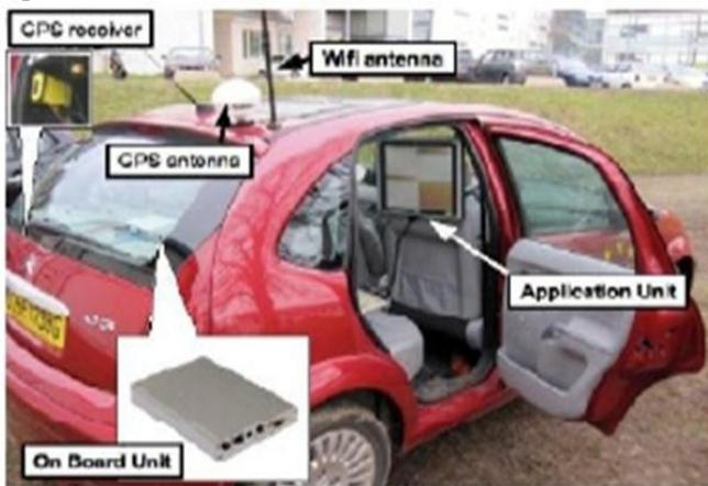
Fig. 3: Example of OBU, AU<sup>[3]</sup>
