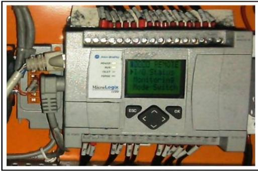
Fig. 13: AB MicroLogix 1100 PLC
