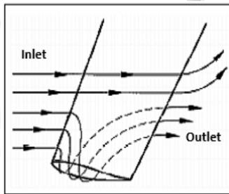
Fig. 4 : Tip Vortex (Leakage)
