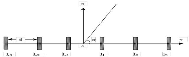
Fig.3: Uniform linear antenna array
