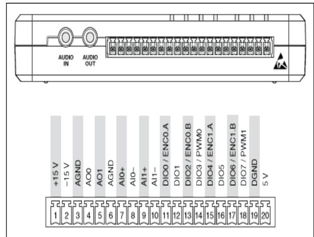
Fig. 4: Pin out diagram of NI-myRIO mini system port
