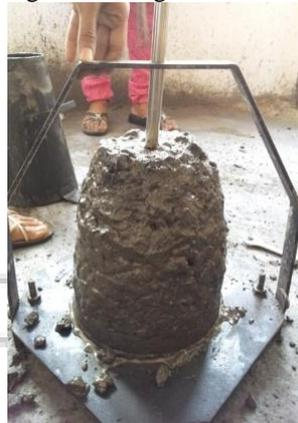
Fig. 4: Slump Test
