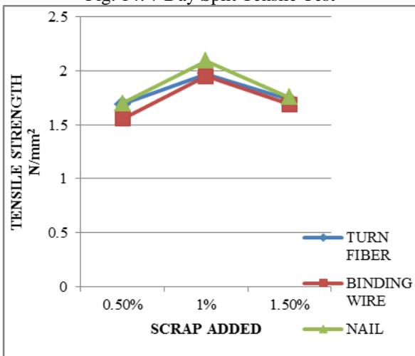
Fig. 15: 28 Day Split Tensile Test
