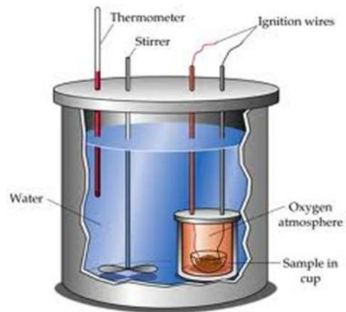
Fig. 2.2: Bomb calorimeter
