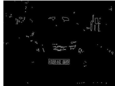
Fig. 4: Sobel vertical edge detection
