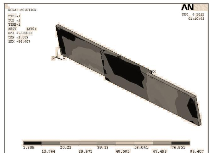
Fig. 12: Joint Plate Ansys Result
