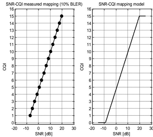
Fig. 4 SNR-CQI Mapping
