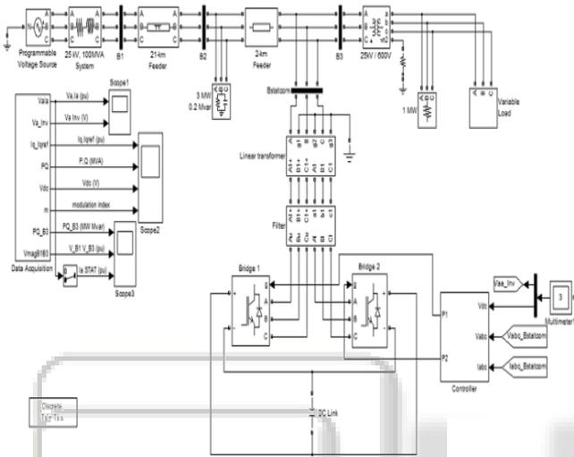
Fig. 3: Simulation of D-Statcom
