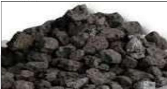
Fig. 2: Steel Slag
